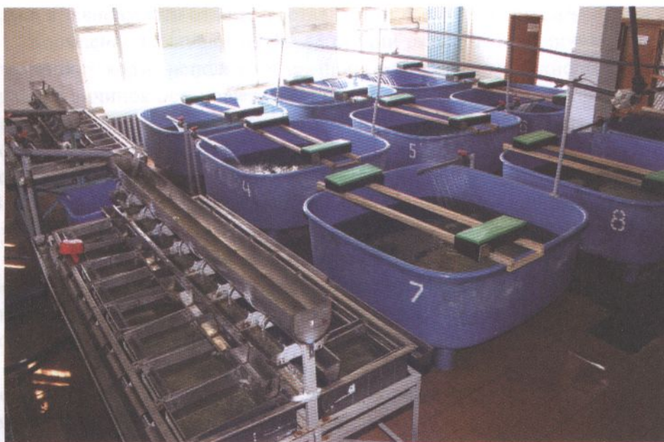
Рис. 4. Инкубационные аппараты "Осетр" и бассейны для содержания предличинок и личинок в НПЦ "БИОС" на участке, работающем как в замкнутом режиме водообеспечения, так и на прямотоке
